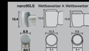
nano95LS hat die kleinsten Abmessungen im Kopf- und Halsbereich und garantiert beste Sicht und einfachen Zugang in jeder Situation.
